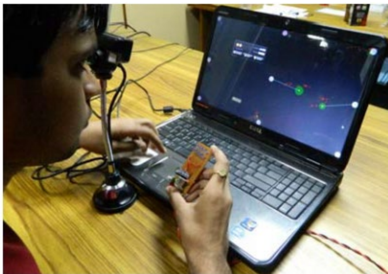
Figura 7 – Dispositivo de entrada proposto por Panwar, Sarcar e Samanta (2012) com o software ITU Gazetracker
