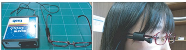
Figura 6 – Dispositivo de entrada adaptado a um óculos proposto por Park et al. (2012)
