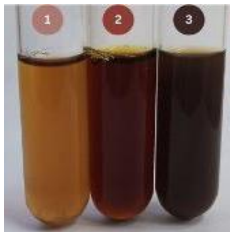
FIGURA 1 – COMPARAÇÃO DE MUDANÇA DE TONALIDADE NO PROCESSO DE SÍNTESE VERDE PARA O EXTRATO AQUOSO DA CASCA DO IPÊ-ROXO COM 4,0 MMOL.L-1 DE \text{AgNO}_3 . (1): AMOSTRA DO EXTRATO AQUOSO DA CASCA DO IPÊ-ROXO; (2) AMOSTRA DO EXTRATO AQUOSO DA CASCA DO IPÊ-ROXO APÓS ADIÇÃO DE \text{AgNO}_3 A 4,0 MMOL.L-1 E (3) AMOSTRA APÓS FORMAÇÃO DAS NANOPARTÍCULAS DE PRATA.
