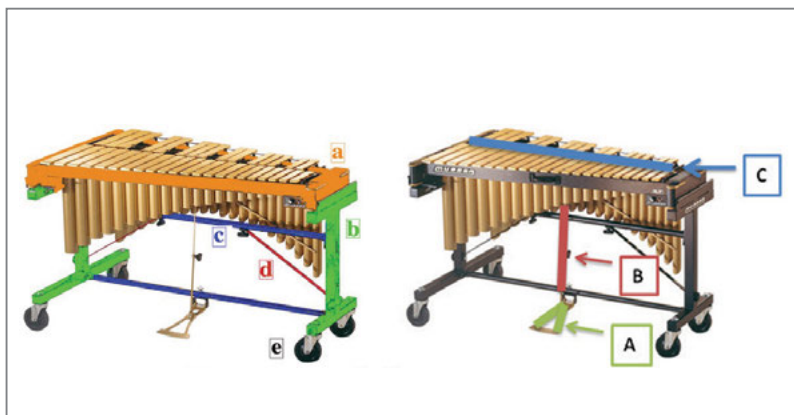
Figura 1 Vibrafone com indicação das partes constituintes do frame (indicadas à esquerda com letras minúsculas) e das partes constituintes do sistema de abafamento (indicadas à direita com maiúsculas)
