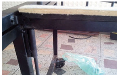
Figura 15 Sixxen: detalhe do frame , suporte das teclas e pedal de abafamento
