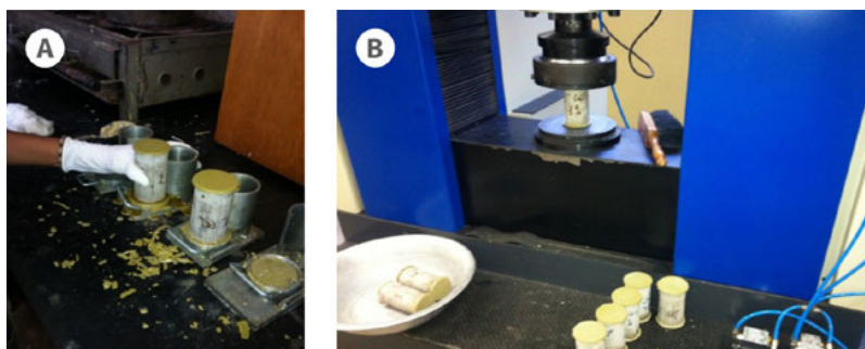
Figura 5 Ensaio de resistência à compressão do cimento: (A) capeamento dos CPs e (B) aplicação de carga
