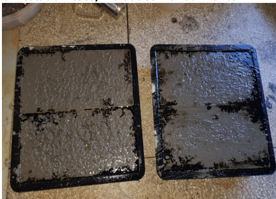
Figura 5 – Blocos de concreto para pavimentação em estado fresco, moldados manualmente
