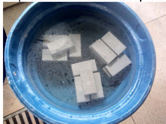
Figura 6 – Blocos de concreto armazenado em solução saturada de hidróxido de cálcio para cura
