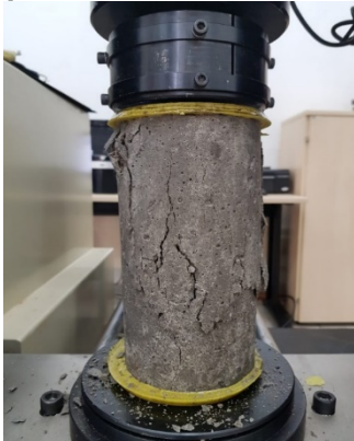
Figura 3 – Ensaio de compressão uniaxial de corpo de prova em formato cilíndrico
